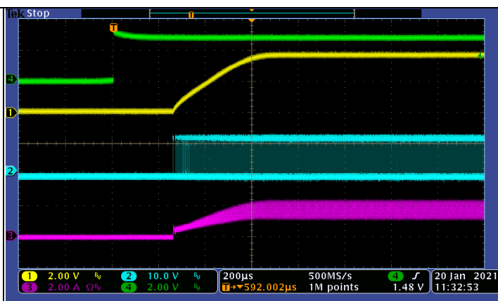
图 8 使能启动曲线 ( V_{in}=12V , V_{out}=3.3V , I_{LOAD}=2A )
