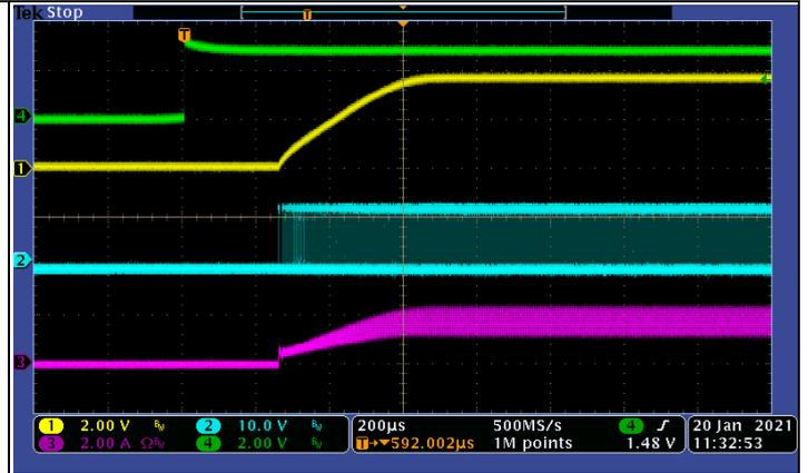
图 8 使能启动曲线 (Vin=12V, Vout=3.3V, I<sub>LOAD</sub>=2A)
